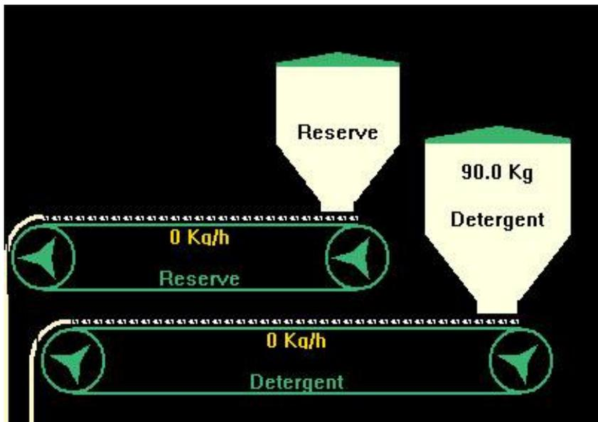
مخزن نوار پودر پایه یا دترجنت که مقدار محتوی آن در لحظه نمایش داده می شود.
